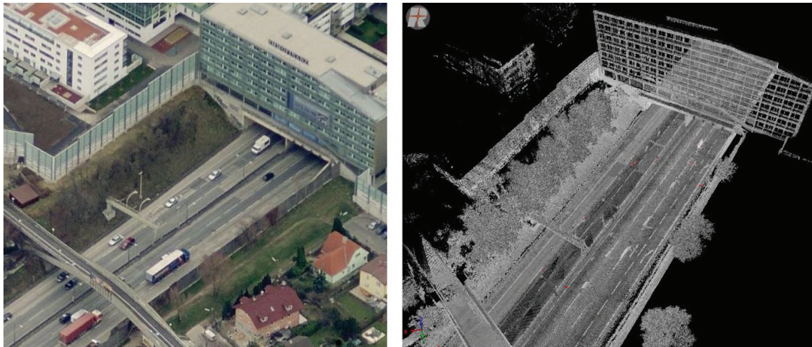
Abb. 10: Datensatz einer Stadtautobahn, aufgenommen mit einer Luftbildkamera (MICROSOFT 2010) (links) und mit dem RIEGL VMX-250 (rechts).
