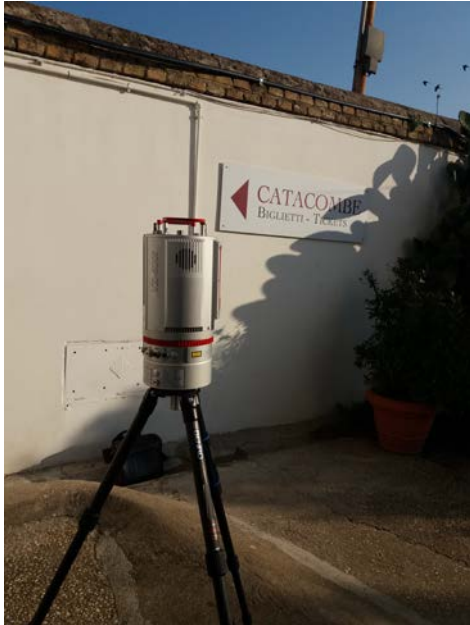
Abb. 4: Scanarbeiten über der Katakombe mit dem Riegl VZ-400i
