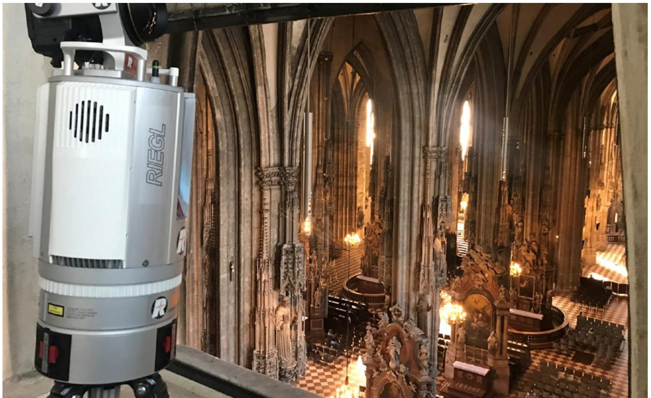
RIEGL VZ-400i Laserscanner bei der Datenaufnahme
