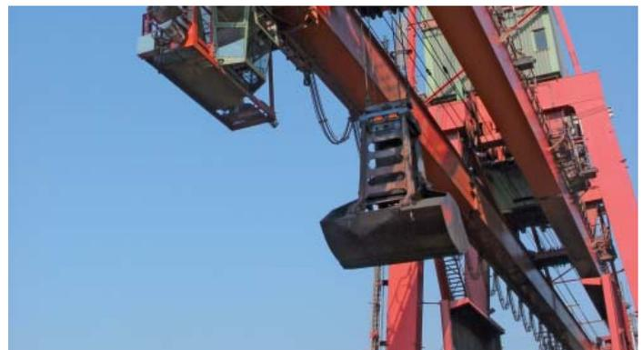
Schiffsentladung bewährt. Das INS wird direkt am Greifer montiert und liefert permanent hochgenaue Lage- und Positionsdaten.
