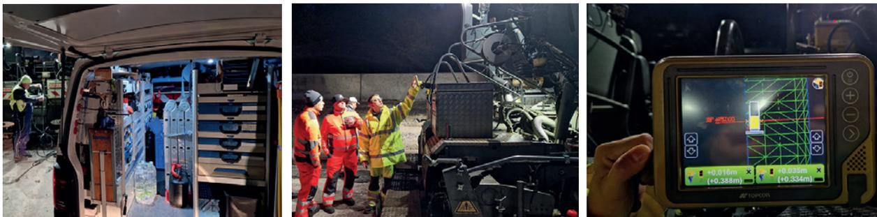
Abb. 14 | 3D-Asphaltfertige Ausrüstung des Super 1800-3i Straßenfertigers (Wirtgen Group 2024) von Vögele mit 3D-Maschinensteuerung
