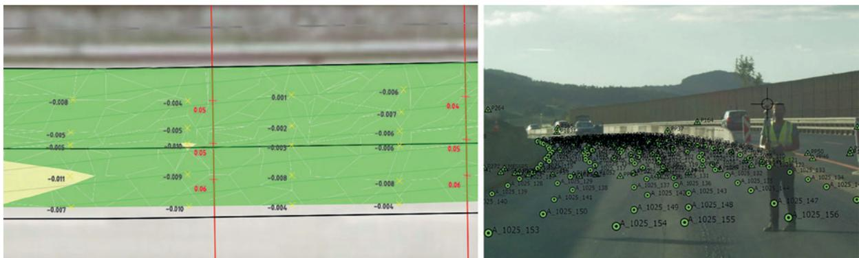
Abb. 16 | Links: Überprüfung der Profilierungsschicht und damit der Einbaugenauigkeit des Bauloses; rechts: Vor-Ort-Überprüfung der Oberfläche der Profilierung mit einer Ein-Mann-Totalstation
