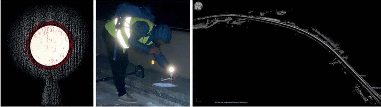
Abb. 9 | Links: Feinscan eines Retro-Reflektors; Mitte: Anbringen eines Reflektors auf einem Bodenpunkt; rechts: Verteilung der Reflektoren entlang der Autobahn
