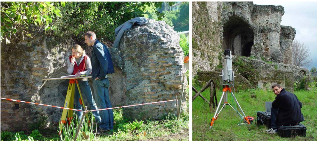
Fig. 2, 3 – Bauaufnahmefethoden: Handaufmaß am Nymphaeum `di ponte spedalato` in Palestrina, terrestrisches Laserscanning am Propylon in Palestrina
