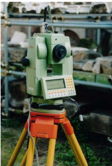
Fig. 4, 5 – Hightech-Messinstrumente: Totalstation Leica TCRM 1103plus und Laserscanner Riegl LMS-Z420i mit Canon EOS 1Ds
