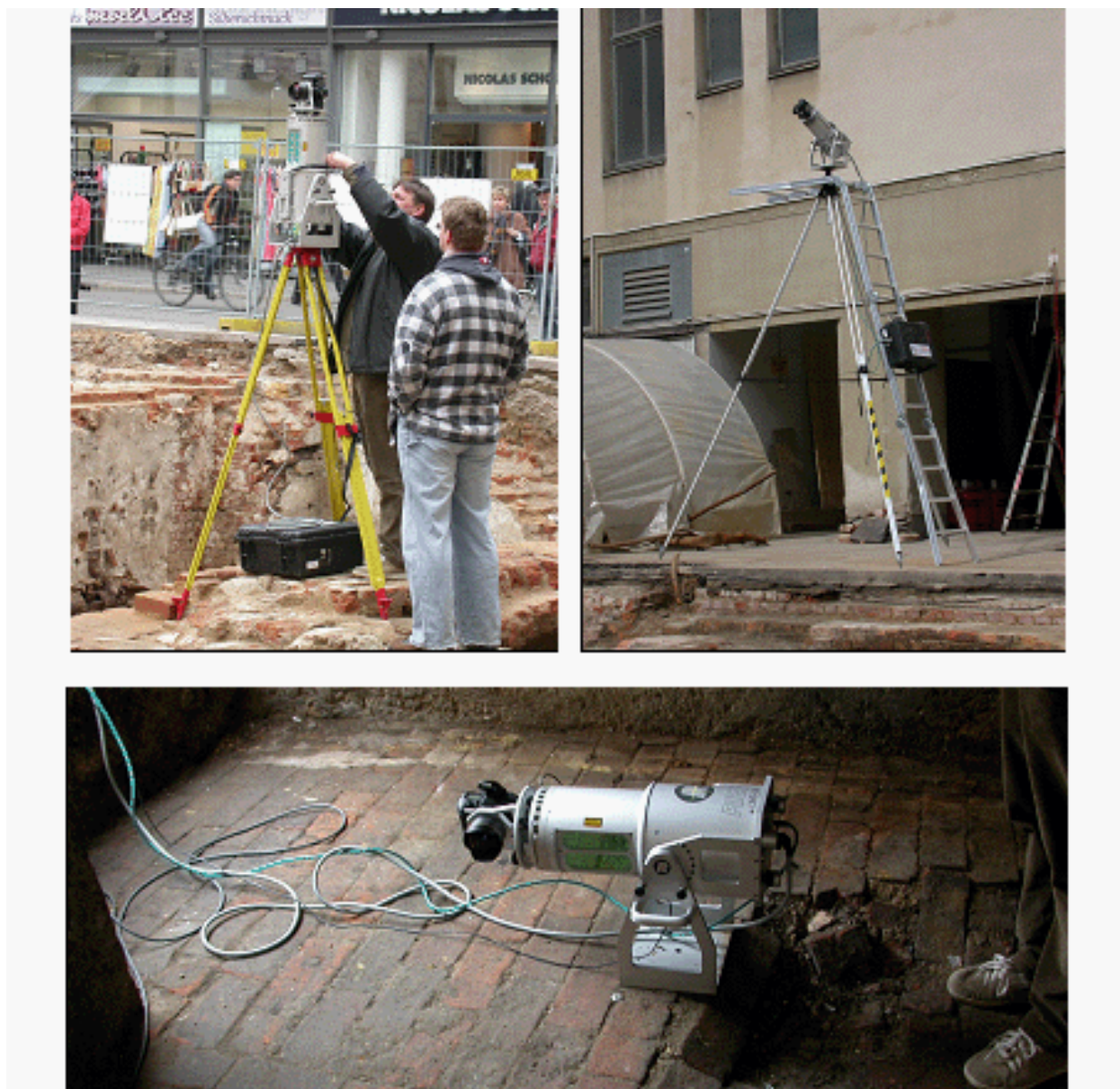
Abb. 4: RIEGL LMS Z420i kombiniert mit NIKON D100 Digitalkamera im Einsatz in Leipzig. Die überhohen Stative und die Schwenkmontage des Scanners ermöglichen es alle notwendigen Positionen für eine umfassende Erfassung der komplizierten Kellerstrukturen einzunehmen.
