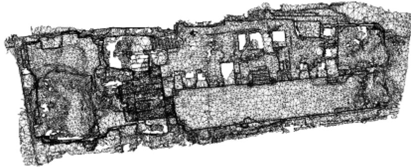
Abb. 17 : In PolyWorks trianguliertes mesh der Parzelle Petersstrasse 33.
