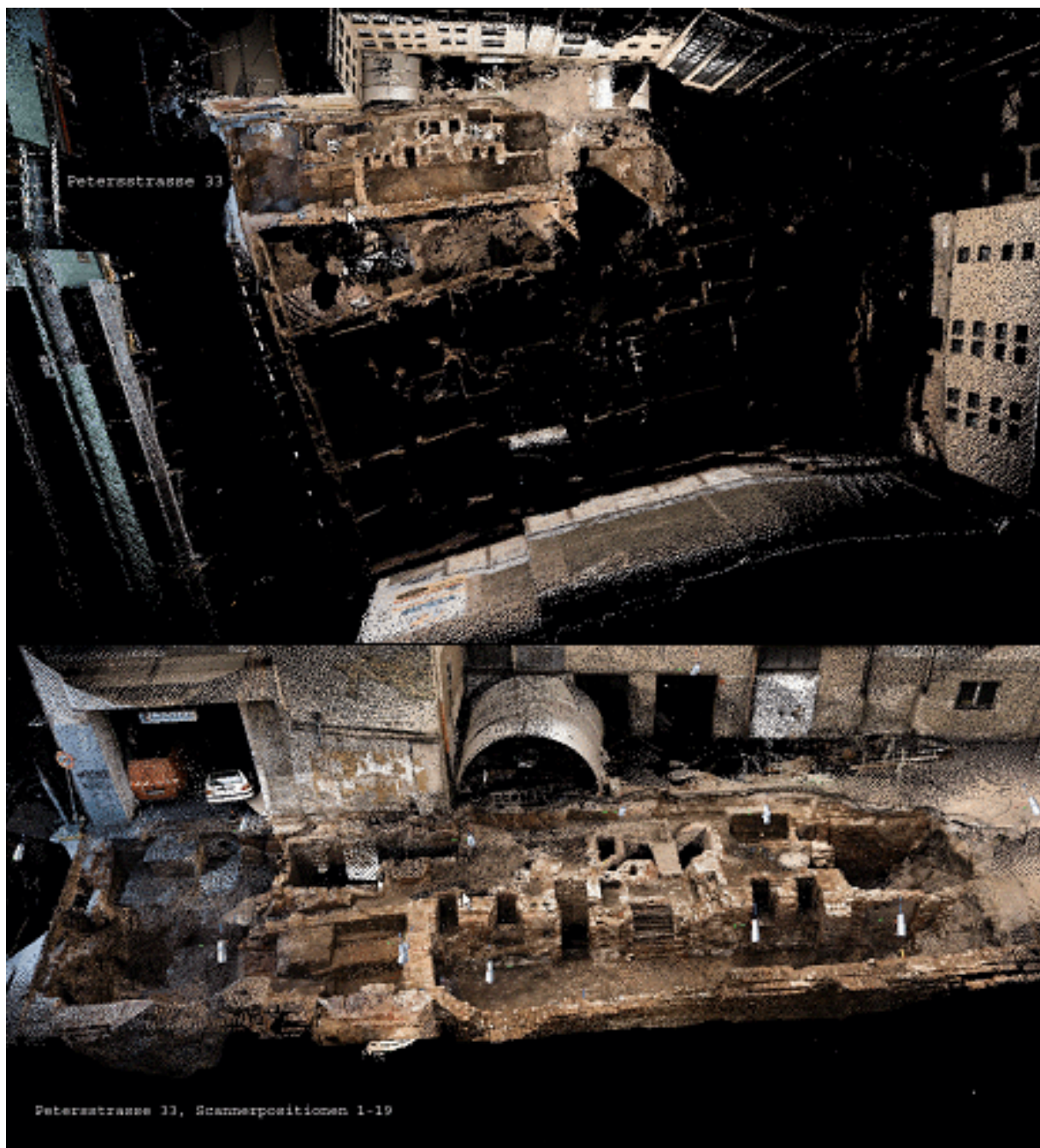
Abb. 1: Draufsicht und Schrägansicht der auf eine Auflösung von 0.4 gon reduzierten Punktwolke der Ausgrabung Petersstrasse, Karstadt-Areal.
