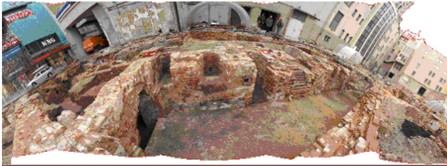
Abb. 7: Beispiel für die 2D Darstellung einer eingefärbten Punktwolke eines einzelnen Scans. In der zweidimensionalen Darstellung der eingefärbten Punktwolke (in einer Azimut-Polar-Winkel Ebene) lässt sich die Qualität der Kamerakalibrierung überprüfen: die einzelnen Fotos gehen ohne erkennbare Stosskanten ineinander über.
