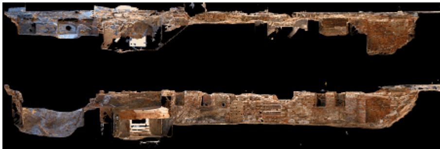
Abb. 23: Orthofotos der Parzelle Petersstrasse 33 in Längsrichtung. Durch Summation der Bereiche vor und hinter der Schnittlinie in beliebig wählbaren Abstand lässt sich eine Grundlage für detaillierte Schnittzeichnungen erzeugen.
