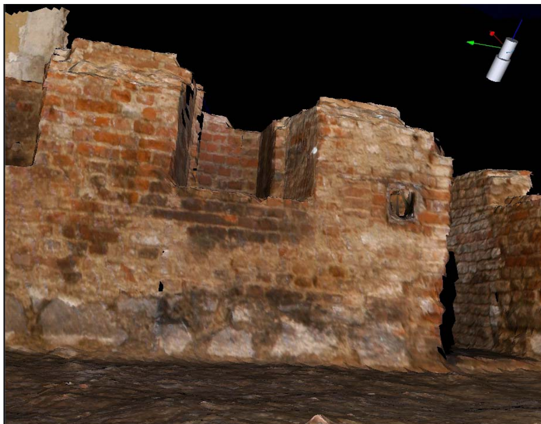
Abb. 16: Ausschnitt des texturierten meshes, das aus mehreren Teilnetzen von verschiedenen Scans in RiSCAN PRO zusammengesetzt wurde.
