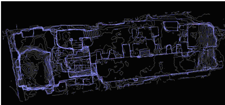
Abb. 19: Höhengschichtenplan in Z-Richtung erstellt aus dem triangulierten Netz mit 10cm Linienabstand.
