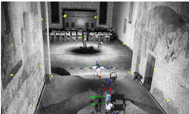
Figura 1. Posizioni del TLS, target riflettenti e punti acquisiti.
