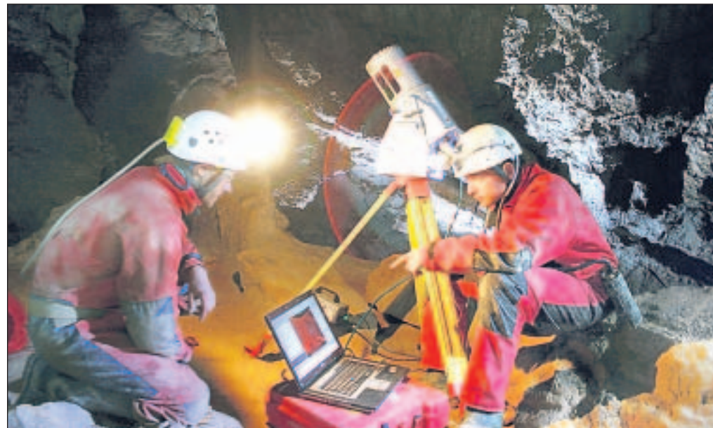
Die Vermessung dieser Höhle erfolgt erstmals mit einem Laserscanner, der den gesamten großen Hohlraum abtastet. Er liefert die Daten für ein exaktes dreidimensionales Abbild (Grafik links).
