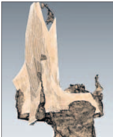
Das ist kein alter Baumstumpf, sondern das dreidimensionale Bild einer mehr als 40 Meter hohen Halle mitten im Berg. Zum Vergleich: Das weiße Netz oben zeigt die bisherige Genauigkeit, dunkel hingegen ist das präzise Modell, welches die Scannerdaten liefern.
