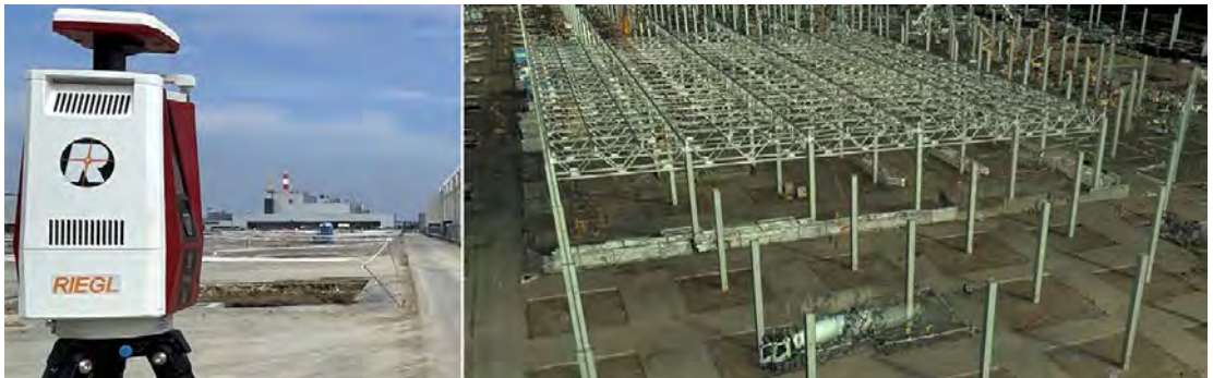
Abb. 14: links: Foto des RIEGL VZ-600i Laserscanners auf einer Baustelle, rechts: resultierende eingefärbte Punktwolke der Baustelle (5 mm Punktauflösung)
