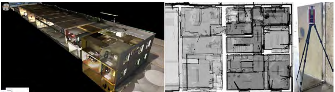
Abb. 9: links: Schrägansicht der eingefärbten Punktwolke, Mitte: orthogonale Ansicht der Punktwolke in der Röntgenansicht, rechts: Foto des RIEGL VZ-600i Laserscanners
