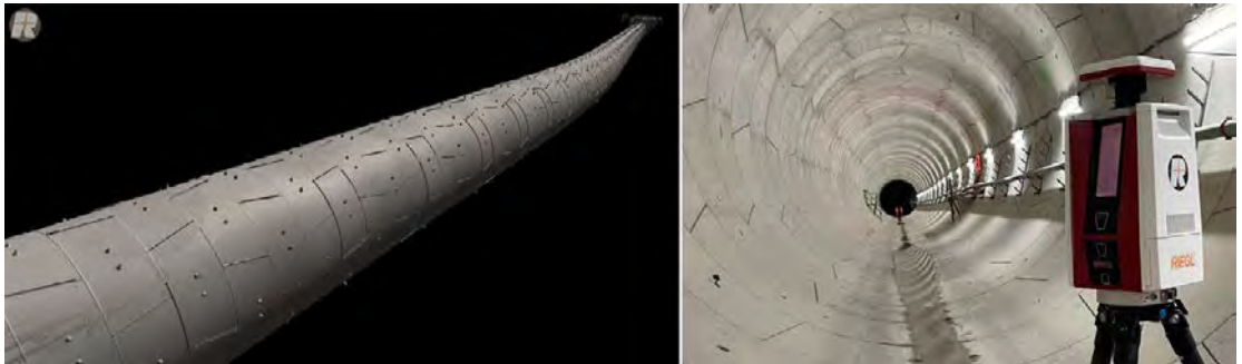
Abb. 8: Punktwolke einer Tunnelröhre
