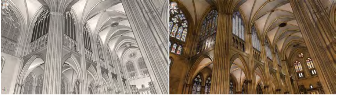
Abb. 2: links: Punktwolke nach Reflexionsgrad grau schattiert, rechts: eingefärbte Punktwolke
