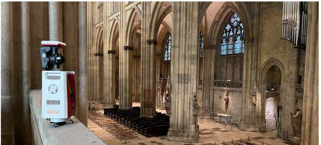
Abb. 12: Foto des RIEGL VZ-600i Laserscanners mit aufgesetzter Sony \alpha 7R IV Systemkamera
